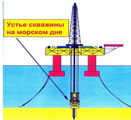
Рисунок 2б. Оборудование устья скважины на ППБУ
