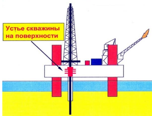
Рисунок 2а. Оборудование устья скважины на СПБУ
