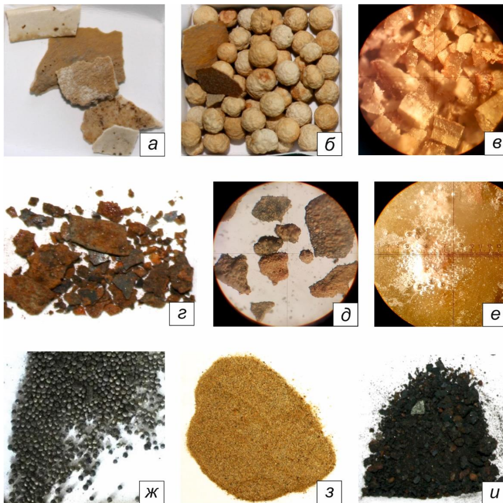
Рисунок 1. Солеотложения и механические примеси, обнаруженные в оборудовании нефтедобывающих скважин. А) и б) – корочки и сферолиты кальцита; в) – раздробленный кальцит под микроскопом, увеличение \times 100 ; г, д) – железистые корочки визуально (г) и под микроскопом с увеличением \times 100 (д); е) – бурное растворение сульфида железа в 3%-м растворе соляной кислоты, под микроскопом с увеличением \times 100 ; ж) – глобулы пропанта; з) – кварцевый песок, мелкозернистый; и) – солеотложения с большим содержанием АСПО.
