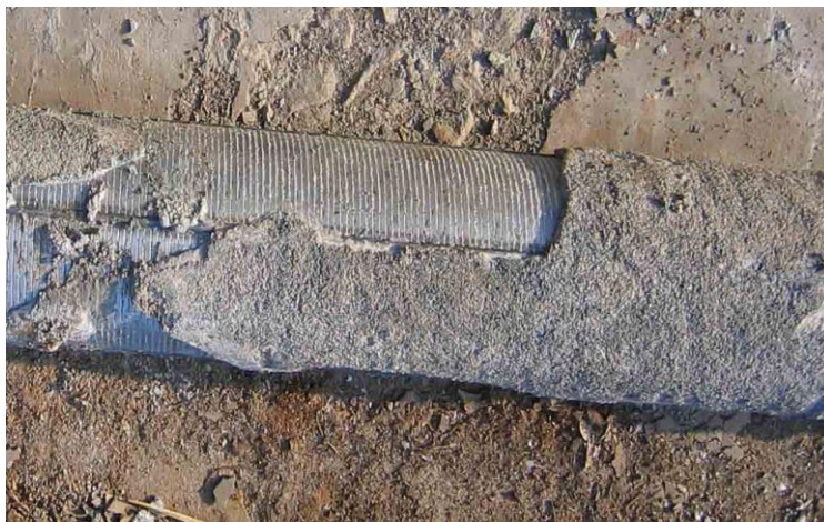
Рисунок 1. Типовой вид закольматированного противопесочного фильтра
